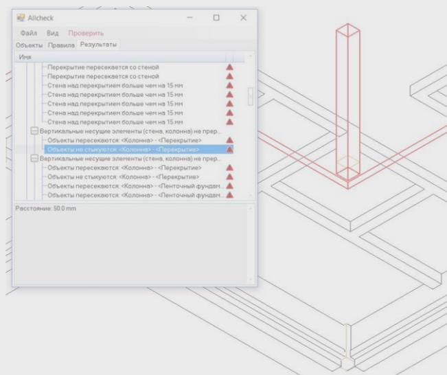
Так, Allcheck поможет отследить «упущенные» проемы и отверстия при взаимодействии архитектора, конструктора и инженера, что позволит избежать дорогостоящих дополнительных работ на стройплощадке.
